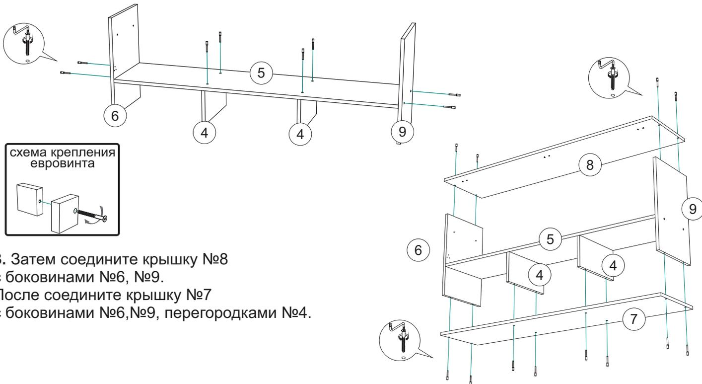
3. Затем соедините крышку №8 с боковинами №6, №9. После соедините крышку №7 с боковинами №6, №9, перегородками №4.
