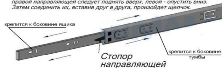
Рис.2 Схема установки шариковых направляющих
