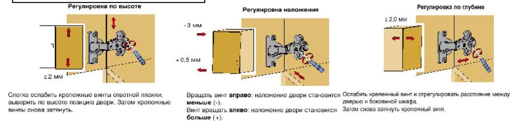
Рис.3 Схема установки петель
