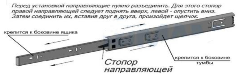
Рис.2 Схема установки шариковых направляющих
