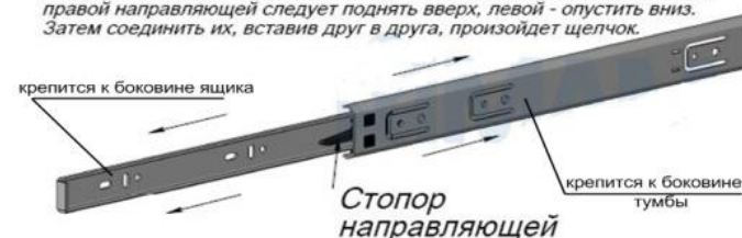
Рис.3 Схема установки шариковых направляющих
